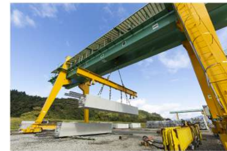
30tや20tの門型クレーンや、40tのクローラークレーンを配置することにより、大型で重量のあるPCa部材の製造が可能 ※写真は30t門型クレーン
