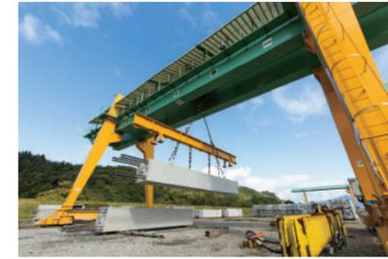
30tの門型クレーンと40tのクロウラークレーンを配置することにより、大型で重量のあるPCa部材の製造が可能
